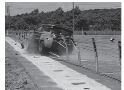
ワイヤロープ式防護柵の衝突実験
