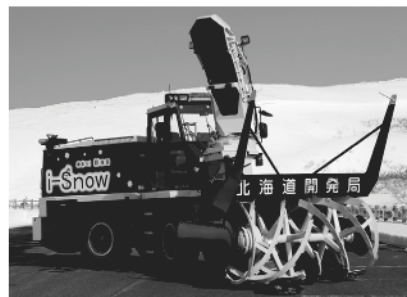
i-Snow実証実験機 ロータリー除雪車
