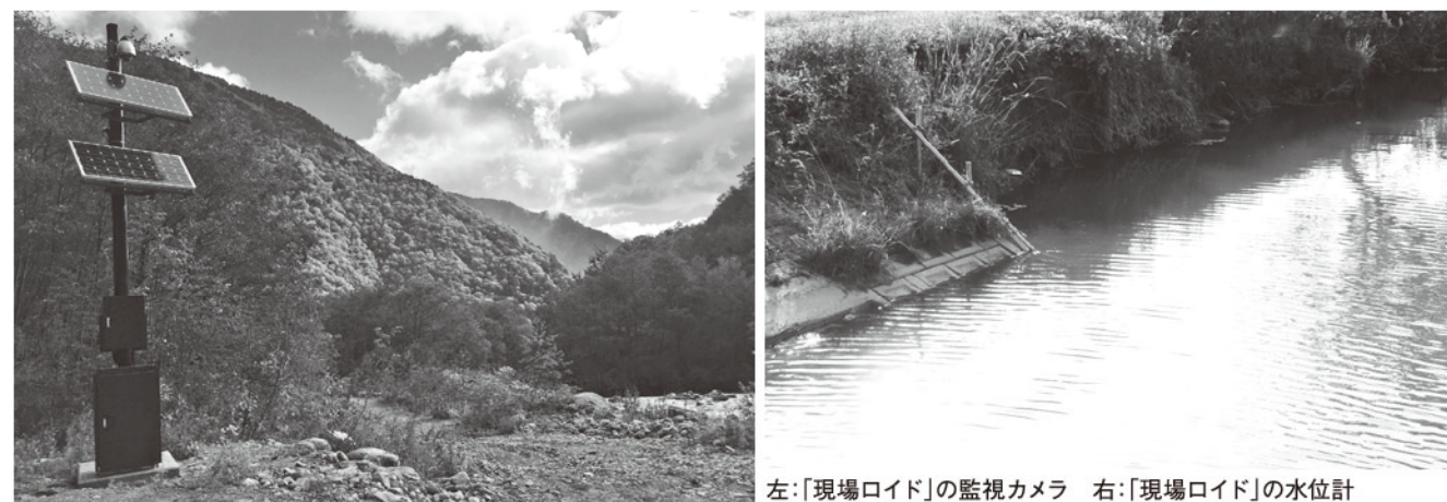
左:「現場ロイド」の監視カメラ 右:「現場ロイド」の水位計
