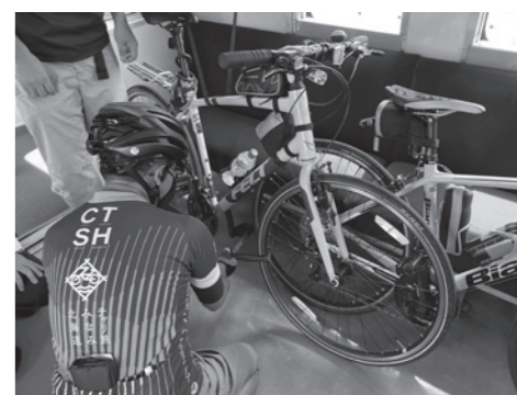
作業時間を計りながら固定方法を検証(事前検証時)
