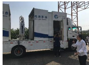
トンネルの補修診断車輛
