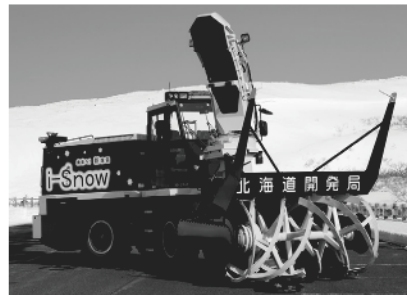
i-Snow実証実験機 ロータリー除雪車
