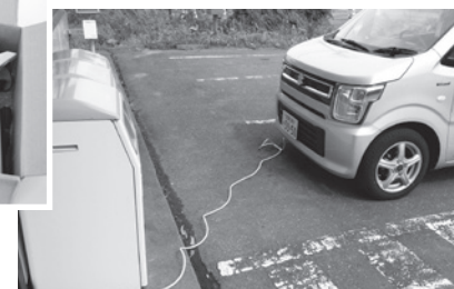
2018年北海道胆振東部地震では、非常電源セットを使用し自動車から電力を引き込みレジを稼働させた
