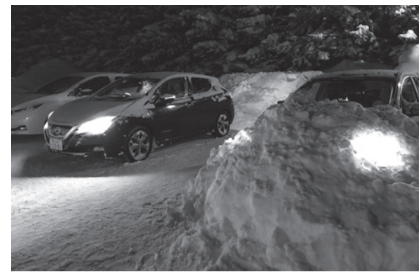
豪雪・暴風雪時における電気自動車(EV)の立ち往生再現実験
