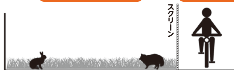
図1: 人と動物がともに利用できるオーバーパスの構造概念。van der Ree et al. (2015) をもとに作成した
