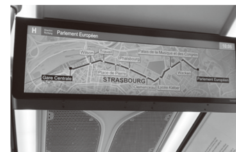
【BRT:Hラインの車内表示】 運行経路と停留所、乗り換え案内が表示されており、車両の走行位置はリアルタイムで反映される。
