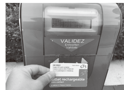
【Strasbourgの認証機】 信用乗車方式が採用されており、乗車前に停留所でチケットの認証を行う。
