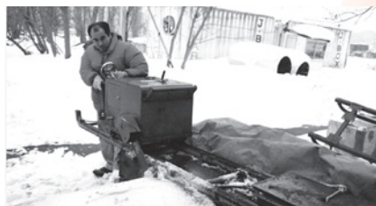
実験用の氷の供試体の製作 様々なタイプのチェーンソーを使うのがうまくなりました(笑)。
