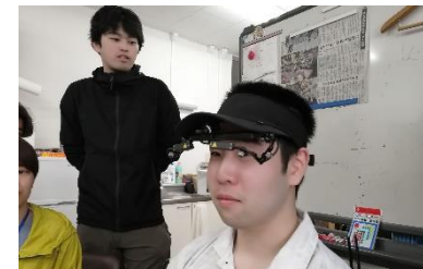
写真2. Eye mark recorder装着の様子 (ドライバーの視認性に関する共同研究)
