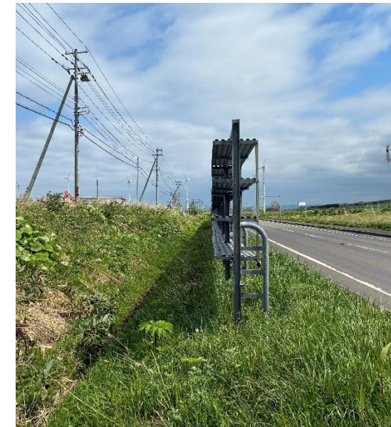
図2. 吹き払い柵風上側が高くなっている例
