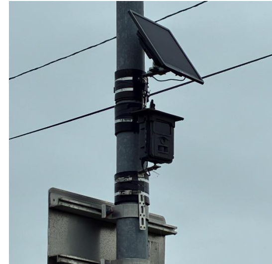
図1. Webカメラの設置例
